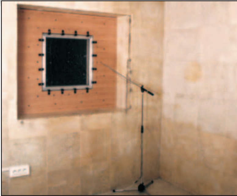
Chambre réverbérante, associée à une chambre sourde. Caractérisation de matériaux et de systèmes destinés aux transports et au bâtiment.
